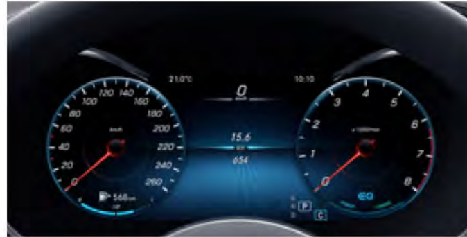
มาตรวัดความเร็ว และวัดรอบเครื่องยนต์แบบ All-Digital Instrument Display ขนาด 12.3 นิ้ว**
