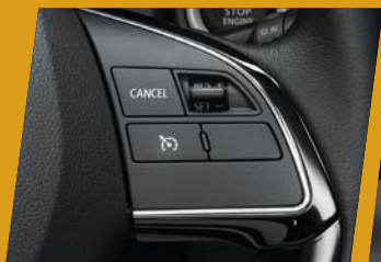
ระบบควบคุมความเร็วคงที่ (Cruise Control)
