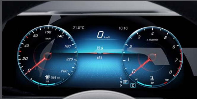
มาตรวัดความเร็ว และวัดรอบเครื่องยนต์แบบ All-digital instrument display
